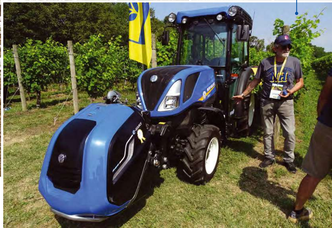
Slopehelper je sicer avtonomno vozilo, ki pa je v osnovi baterijsko kmetijsko vozilo oziroma popolnoma električno kmetijsko vozilo. Nima motorja z notranjim zgorevanjem.
