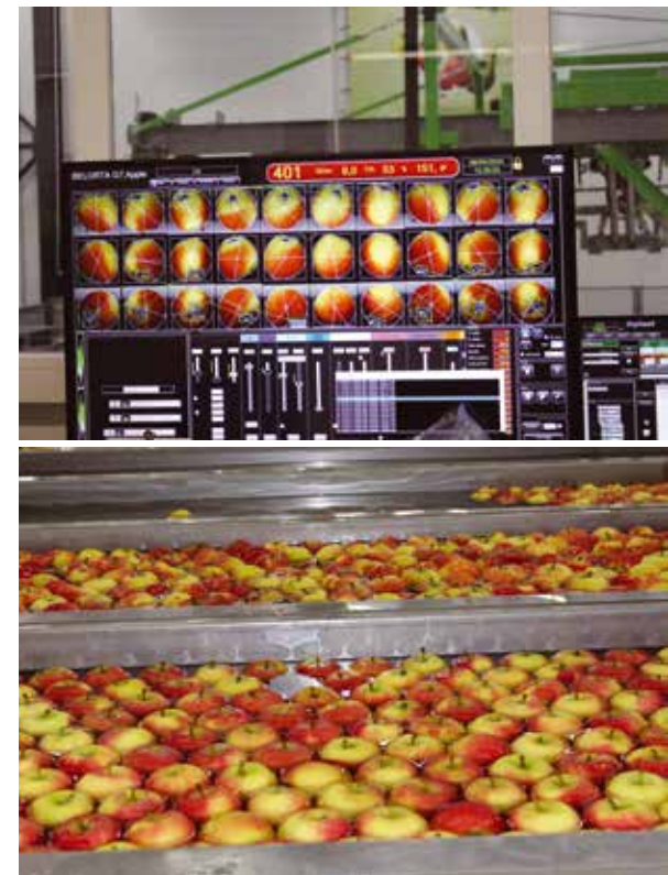
Vsako jabolko je skenirano, tako da odkrivajo zunanje in notranje napake.
