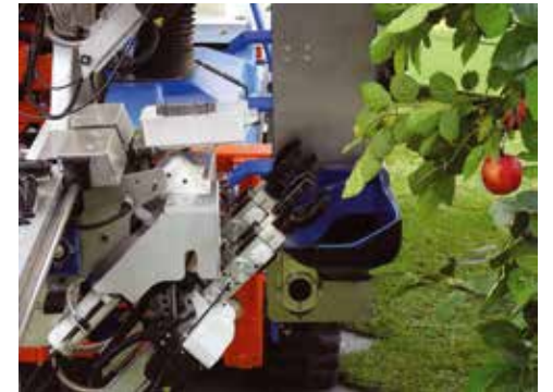
Slopehelper je robot, izdelan v Sloveniji. To je električni avtonomni gumi goseničar. Na sejmu EIMA so z njim prikazali avtonomno obiranje jabolk, kar pomeni še en robotiziran – avtomatiziran sistem na osnovnem pogonskem stroju. Vsaka obiralna roka ima stereo globinsko kamero in manipulator s prijemalom jabolk.
