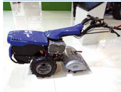
BCS je predstavil električni motokultivator (enoosni traktor) BCS MC 780 E, ki ima dva električna motorja. Eden je za pogon koles, drugi za pogon priključne gredi. To je bila nagrajena tehnična inovacija.
