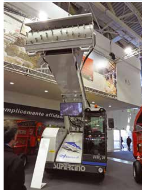
Električna samohodna mešalno-krmilna prikolica Supertino Electra 221.
