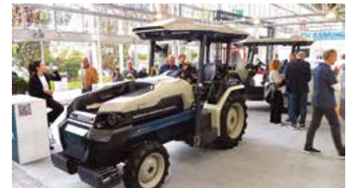
Monarch MK-V je popolnoma električni traktor, ki združuje najnovjšo elektrifikacijo, avtonomijo in pametno tehnologijo. Baterije omogočajo delo do 14 ur, voznik traktorja pa je »opcija«. Tehnologija omogoča namreč avtonomno vožnjo.
